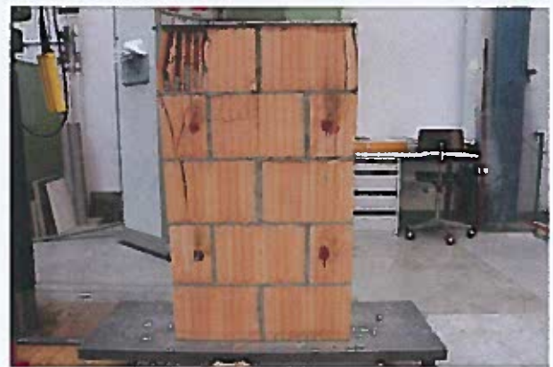
Abbildung 6: Mauerwerkskleinkörper Nr. 2.2 nach Versuch. Aus der Prüfmaschine herausgefahren.
