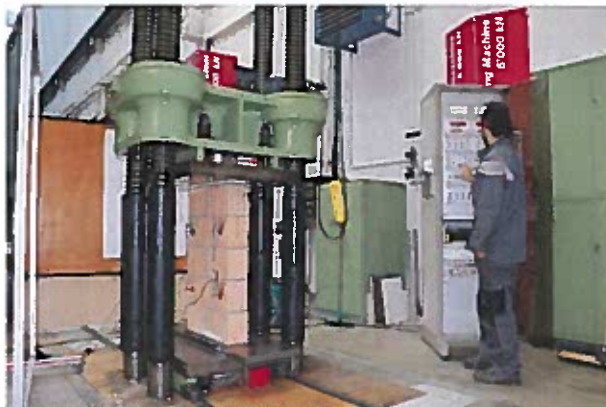
Abbildung 3: Mauerwerkskleinkörper 2.3 in der 5'000 kN Druck-Prüfmaschine eingebaut.
