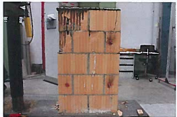
Abbildung 8: Mauerwerkskleinkörper Nr. 2.3 nach Versuch. Nach Abbau der Weggeber und aus der Prüfmaschine herausgefahren.
