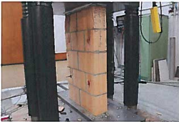
Abbildung 5: Mauerwerkskleinkörper Nr. 2.2 nach Versuch.
