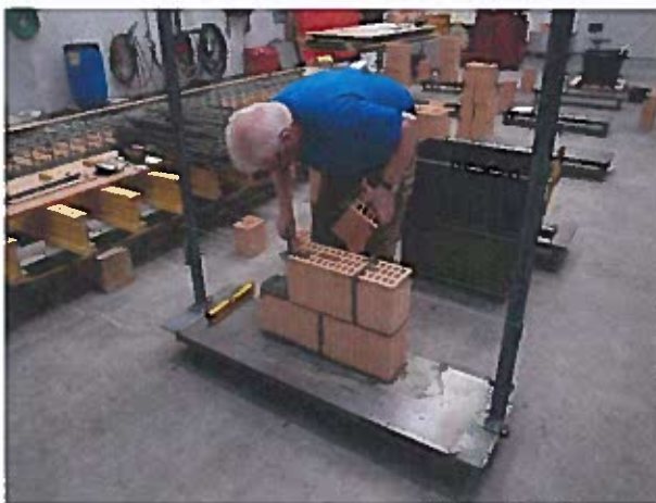
Abbildung 1: Aufmauern eines Mauerwerkskleinkörpers der ersten Prüfserie.
