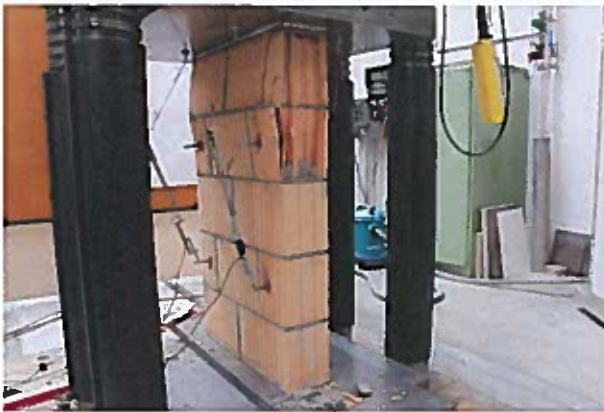
Abbildung 7: Mauerwerkskleinkörper Nr. 1.2 nach Versuch.
