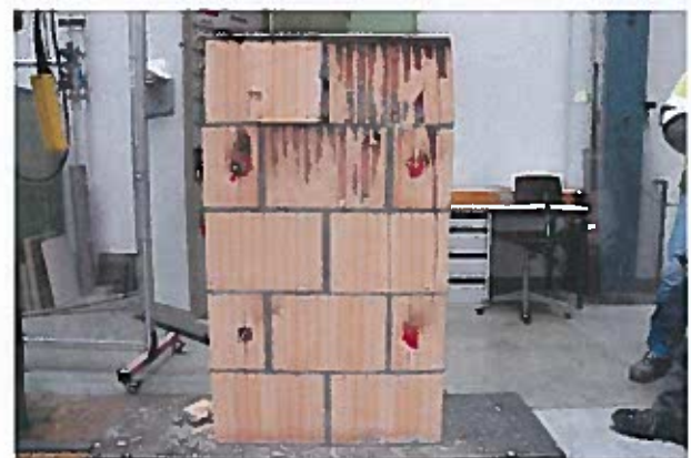
Abbildung 10: Mauerwerkskleinkörper Nr. 1.3 nach Versuch. Nach Abbau der Weggeber und aus der Prüfmaschine herausgefahren.
