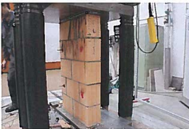
Abbildung 9: Mauerwerkskleinkörper Nr. 1.3 nach Versuch.
