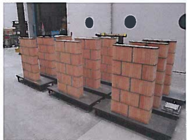
Abbildung 2: Mauerwerkskleinkörper während der Lagerung (drei Prüfserien à drei Mauerwerkskleinkörper).
