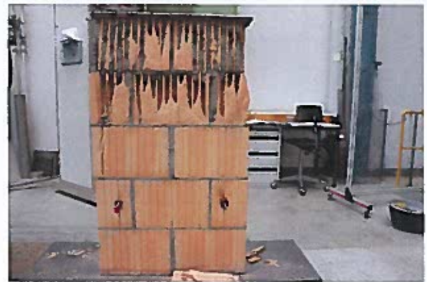
Abbildung 8: Mauerwerkskleinkörper Nr. 1.2 nach Versuch. Nach Abbau der Weggeber und aus der Prüfmaschine herausgefahren.
