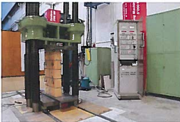
Abbildung 3: Mauerwerkskleinkörper in der 5'000 kN Druck-Prüfmaschine eingebaut.
