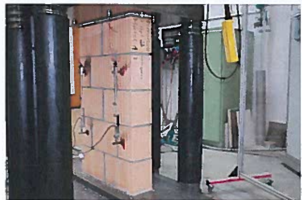
Abbildung 4: Mauerwerkskleinkörper mit zwei Wegaufnehmern. Auf der anderen Seite waren ebenfalls zwei Wegaufnehmer angeordnet.
