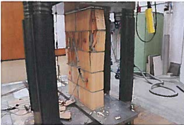
Abbildung 5: Mauerwerkskleinkörper Nr. 1.1 nach Versuch.
